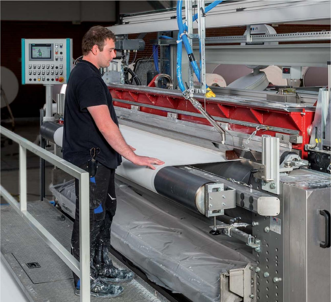
➤ Technische Textilien und beschichtete Textilien stellen hohe Anforderungen an die Flexibilität des Herstellers. Daher muss auch die Textilmaschine an genau diese Bedürfnisse flexibel anpassbar sein. Monforts bietet dazu maßgeschneiderte Lösungen aus einer Hand: Die jeweiligen Beschichtungsmodule können mit und ohne Magnetsystem eingesetzt werden. Für Arbeitsbreiten über 240cm empfiehlt sich der Einsatz eines sogenannten Magnetrakels.
